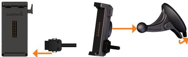
3. 将固定座支架对准设备底部的凹槽处，向设备内推进，当出现咖擦声响，即代表设备已与固定座连接。
