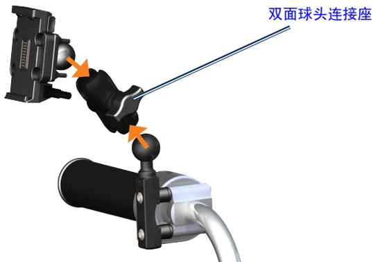
4. 将zūmo主机装至zūmo固定座，即完成机车固定座的安装
