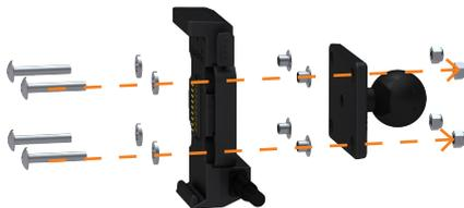
3. 组合zūmo固定关节，用双面球头连接座连接zūmo专用固定座及机车手把固定底座，并通过旋钮旋紧固定角度
