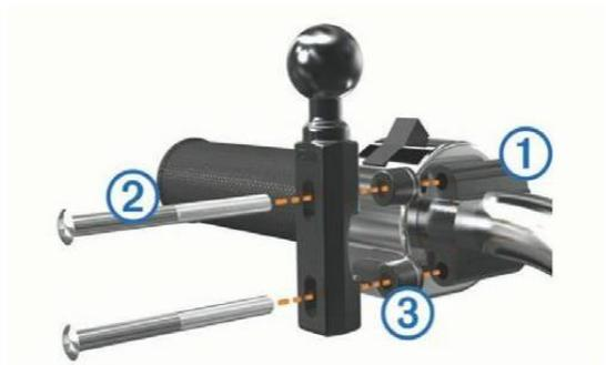
**注意:**包含 1/4 英寸标准螺栓和 M6 螺栓。
