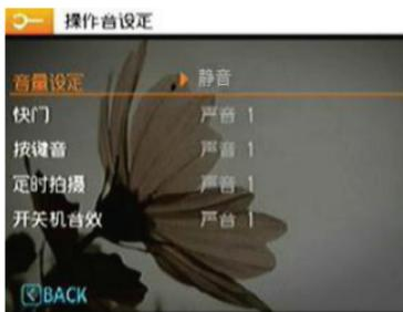
3. 按下**向右**键进入，并按压**向上/下**按钮以调整音量和更换各项声音，然后再按下
