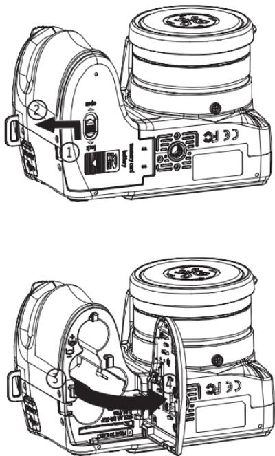
2. 将电池依正确方向装入电池槽中。
