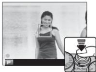
◆ 对焦和曝光也可分别使用 **AF-L** 和 **AE-L** 按钮进行锁定（若将拍摄菜单中的 **AF-L AF-LOCK 模式** 选为 **AE/AF-LOCK**，按下 **AF-L** 按钮将同时锁定对焦和曝光；见 96）。
