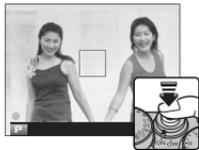
◆ 无论是否半按快门按钮，按住 **AF-L** 或 **AE-L** 按钮时对焦和/或曝光都将保持锁定。若 **AE/AF-LOCK 设定**（见 96）选为 **AE/AF-LOCK 开关切换**，按下按钮时对焦和/或曝光将会锁定，并且保持锁定直至再次按下该按钮。
