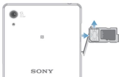
! Nano SIM 卡和記憶卡共用一個卡座。如果已將記憶卡插入裝置，您必須先關閉裝置，或先卸載記憶卡，再拉出卡座，以取出 SIM 卡。您可以在**設定**中，輕按**儲存空間>卸載 SD 卡**，來卸載記憶卡。
