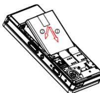
3. 按箭头①所示方向推 microSD 卡盖，然后按箭头②所示方向打开 microSD 卡盖。
