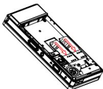
2. 请先确认电池的正反方向，拉住电池上方的拉手，按照箭头①所示的方向将电池顶端的金属接触面插入电池槽，然后按照箭头②所示的方向放入电池。
