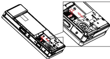
4. 按箭头①所示方向插入 microSD 卡，然后按照箭头②所示的方向将 microSD 卡盖按下放平。
