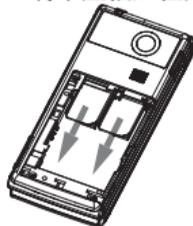
4. 将卡插入左侧的卡槽1或右侧的卡槽2。
