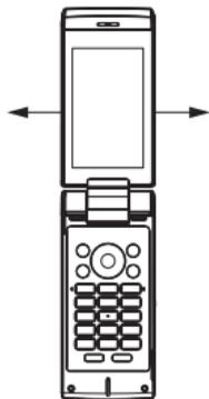
“图像浏览”：允许通过向侧面摇动手机来切换显示的图像。允许通过向前或向后摇动手机来放大或缩小图像。
