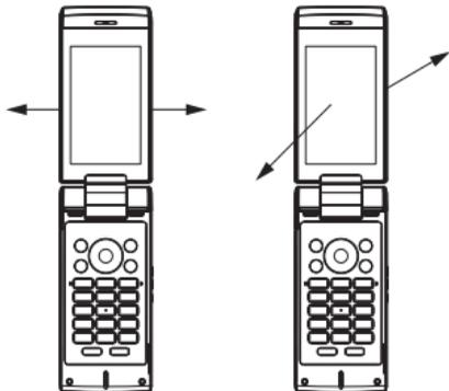
“墙纸”：允许手机在待机状态下，通过向侧面摇动手机来切换显示的墙纸。
