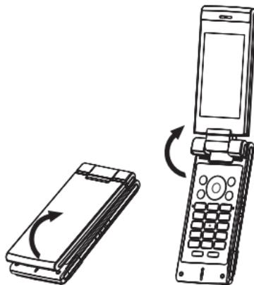
如果开盖应答打开，手机处于开机状态时，您可通过打开手机盖来接听来电。
