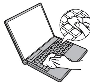
3 慢慢举起计算机，保持水平，并用柔软干布拭去底部孔隙流出的液体。
