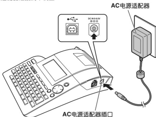
**1** 将 AC 电源适配器的连接插头牢固地插到本机的 AC 电源适配器插口上。
