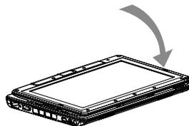
\* 注意：请注意，此萤幕只能顺时针旋转180度。务必依照标志说明旋转萤幕。依错误角度强制旋转萤幕会严重损坏T1028(M1028)。
