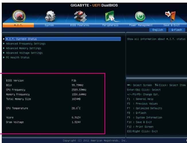
此画面提供BIOS版本、CPU基频、CPU时钟、内存时钟、内存总容量、CPU 温度、Vcore和内存电压的相关信息。
