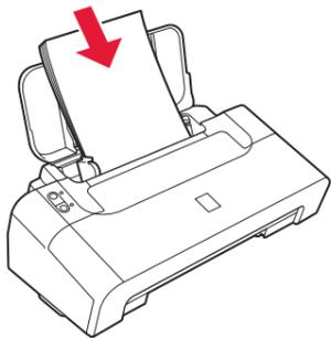
3 调整纸张导片以适合纸张宽度。
