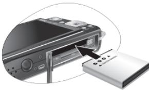
3. 將電池推到底，直到電池鎖門卡入定位為止 (C)。
