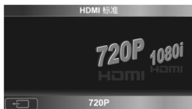
备注：接高清电视时，由于DSP的局限性不能对1080P和720P60两种格式进行录影，拍照OK。
