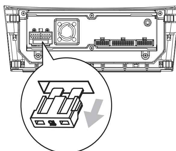
如果更换后保险丝立即熔断，则可能存在内部故障。在这种情况下，请咨询 Philips 经销商。
