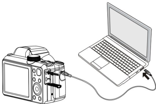
4. 传输完成后请依照所使用电脑的系统安全移除USB设备的方式移除USB连接线。
