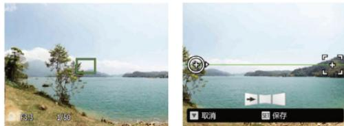
5. 照相机自动将拍设的照片拼接成全景照片，拼接完成后预览1秒。
