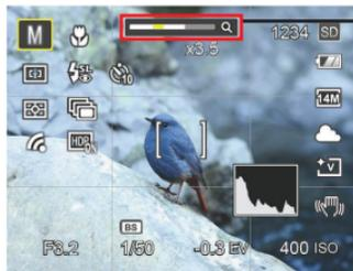
当光学变焦达到与数码变焦的临界点时，松开并再次将变焦杆拨向T端，就会自动完成光学和数码变焦的切换。
