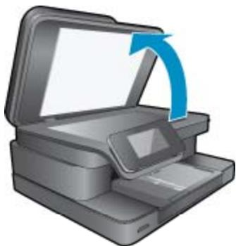
将原件打印面朝下放到玻璃板的右上角。
