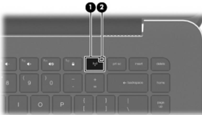
如果无线指示灯为琥珀色，则表示一个或多个无线设备处于关闭状态。如果无线指示灯关闭，则表示一个集成的无线设备处于打开状态（例如无线局域网 (WLAN) 设备和/或 Bluetooth® 设备）。
