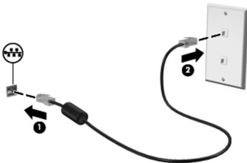
⚠ **警告！** 为减少电击、火灾或损坏设备的危险，请不要将调制解调器电缆或电话线插入 RJ-45（网络）插孔。
