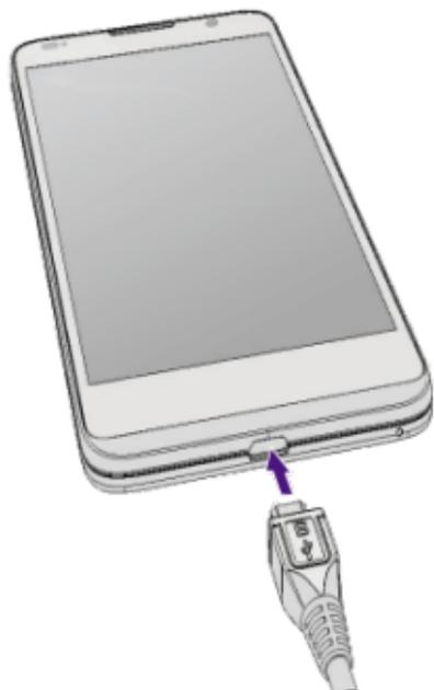
1. 將 USB 連接線的較小一端接頭插入手機的 Micro USB 連接埠。
