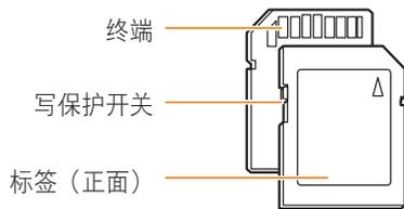
使用 SD、SDHC 或 SDXC 存储卡上的写保护开关、可以防止删除文件。向下滑动写保护开关可将其锁定、向上滑动则可解除锁定。拍摄相片或视频时、解除锁定存储卡。
