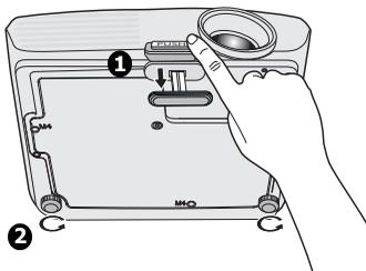
要收回支脚，抬起投影机并按下快速装拆按钮，然后慢慢向下压投影机。接着按反方向旋转后调节支脚。
