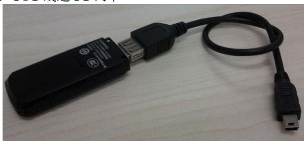
图 3: OTG 线连 3G 网卡
