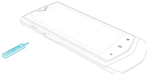
2. 轻轻推，一直到卡套弹出，然后从卡套槽内完全拉出卡套。
