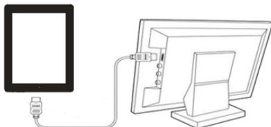
本機支援高清（HDMI）介面，您可以連接本機至數位電視機等顯示、音視頻輸出設備。HDMI 連接能提供高品質的音、視訊訊號。
