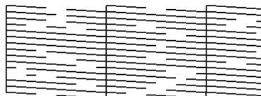
图案显示有任何缺失执行打印头清洗。
