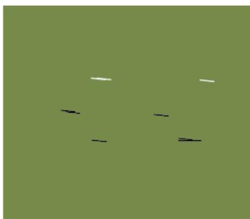
在打印期间，介质和打印头发生接触。
