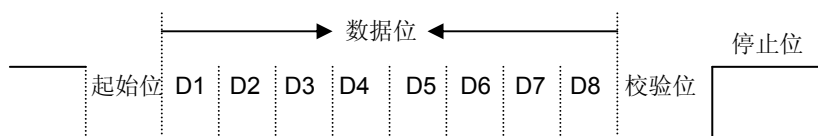
图 B-8 串行数据格式
