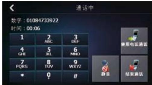
要静音MOTONAV TN30车载免提导航仪麦克风，点击“**静音**”。通话静音后，图标变为“**结束静音**”。要取消静音MOTONAV TN30车载免提导航仪麦克风，点击“**结束静音**”。图标变回“**静音**”。
