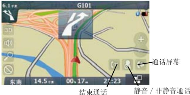
要静音MOTONAV TN30车载免提导航仪麦克风，点击“**静音**”图标。通话静音后，图标变为“**结束静音**”。要取消静音MOTONAV TN30车载免提导航仪麦克风，点击“**结束静音**”图标。图标变回“**静音**”。
