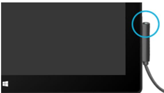
接头顶端的小灯亮起表示 Surface 平板电脑已接通电源。
