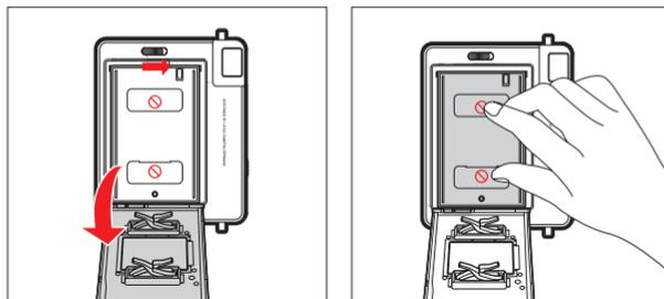
計數器顯示剩餘相片數量，一開始顯示 10。當顯示 0 時，您就可以將空的膠捲包取出了。
