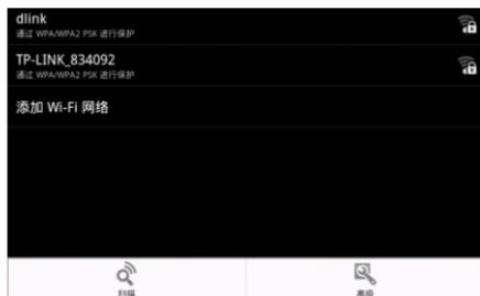
点触“高级”选项，即可进行静态IP、IP地址、网关等参数的设置。DNS的IP地址，请在IP设置的“域名1”选项中填写。备用DNS的IP地址，请在“域名2”中填写。填写后，请将Wi-Fi关闭，再重新打开后，T10的Wi-Fi设置即可生效。
