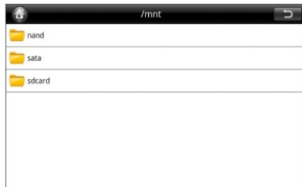
“nand”文件夹为系统内存文件夹，“sdcard”文件夹为TF卡文件夹。点触打开一个文件夹，即可点触打开文件夹中的视频文件进行播放。
