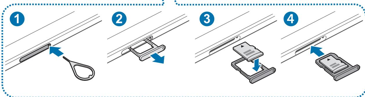
1 将取卡针插入存储卡托上的小孔弹出卡托。
