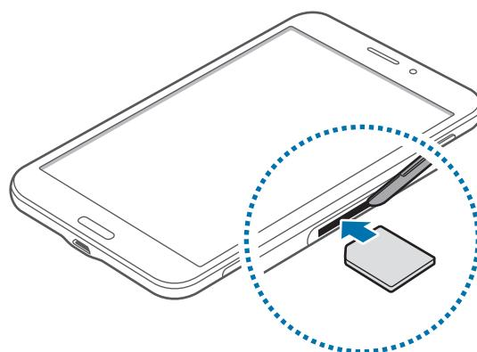
3 将 SIM 或 USIM 卡推进插槽，直至锁定到位。
