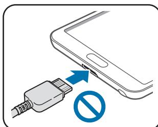
使用 USB 2.0 数据线时，将 USB 数据线按照下图所示插入多功能插口的右侧。
