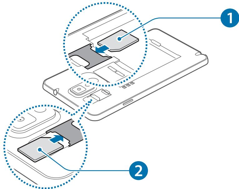
3 将 SIM 或 USIM 卡推进插槽，直至锁定到位。
