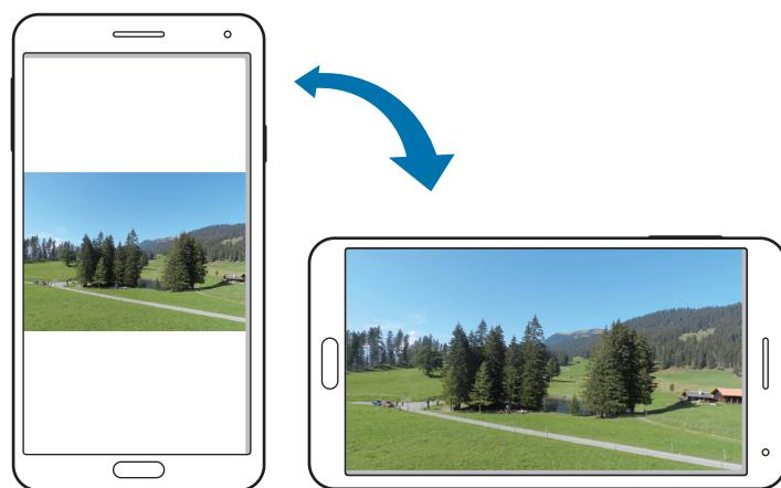
如欲防止显示屏自动旋转，打开通知面板，然后取消选择**屏幕旋转**。
