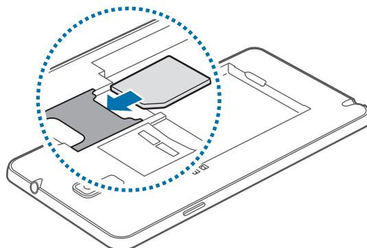
**3 将 SIM 或 USIM 卡推进插槽，直至锁定到位。**
