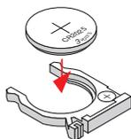
拆下舊電池並裝上新電池(CR2025)。確定「+」面朝上。
