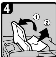
· 如果无法取出卡住的原稿，请打开 ARDF 外盖，然后取出卡住的原稿。
