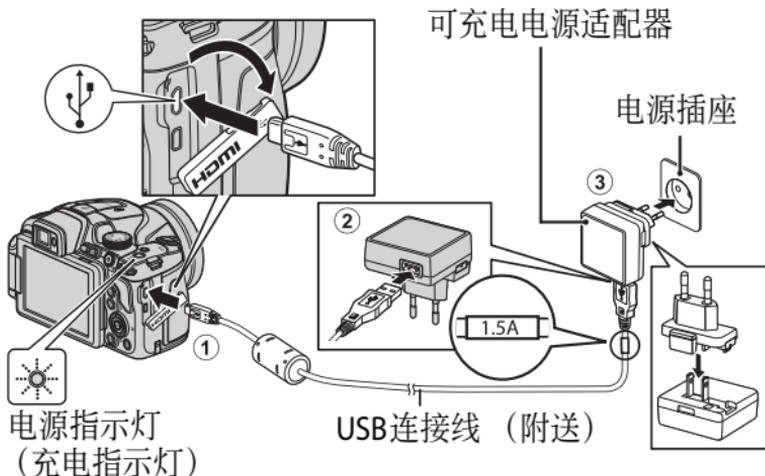
如果随您的照相机附送了插头适配器\*，将其牢固地连接到可充电电源适配器上。将两者相连后，强行用力取出插头适配器可能会损坏产品。
