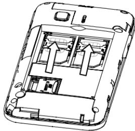
4. 按下图中箭头所示的方向掀起存储卡固定架，将存储卡缺口方向依照卡槽形状放入，然后平推关闭存储卡固定架。
