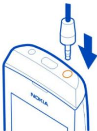
請勿連接會產生輸出訊號的產品，以免造成裝置損壞。請勿在諾基亞 AV 插孔處連接任何電源。如果連接任何非諾基亞認可用於搭配本裝置的外部裝置或耳機至諾基亞 AV 插孔，請特別注意音量級別。
