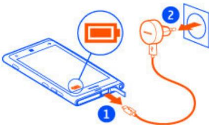
要避免损坏充电器插孔，在连接充电器线缆或断开连接时请小心。
