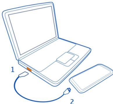
2 当电池完全充电后，请先断开 USB 数据线与手机的连接，再断开其与计算机的连接。
