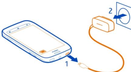
要避免损坏充电器插孔, 在连接充电器线缆或断开连接时请小心。
