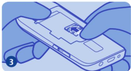
向手机底端滑动存储卡卡
