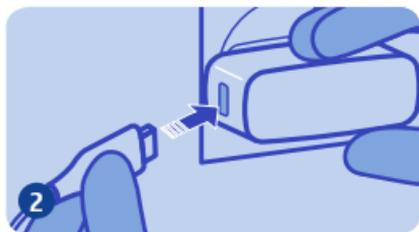
2 将充电器的连接线插头插入充电器。
