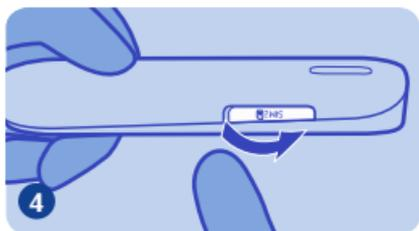
4 要取下 SIM 卡，请打开 SIM 卡插槽。
