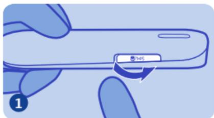
1 打开带 SIM 2 的外部 SIM 卡插槽。请参见 → 7。
