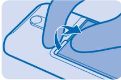
3. 将 SIM 卡滑入卡夹，并使触点朝下。
