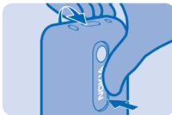
2. 使触点朝下，推入存储卡。
