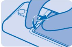
3. 将 SIM 卡滑入卡夹，并使触点朝下。要插入第二张 SIM 卡，请将其滑入另一个卡夹。
