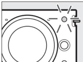
**遙控模式：**將 ML-L3 對準相機上的紅外線接收器 (
