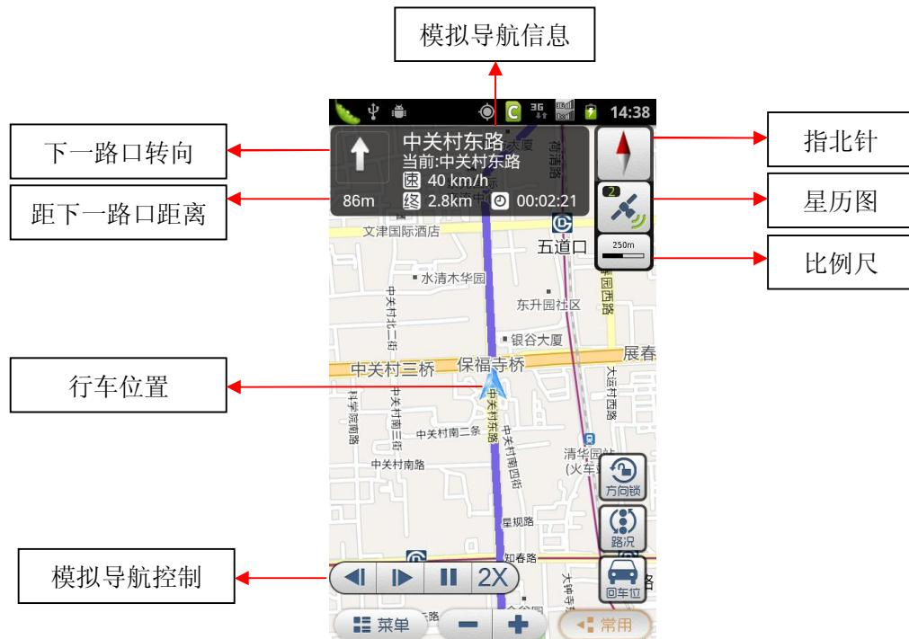
**模拟导航控制:**包括后退、前进、暂停/启动、速度调节四个功能按钮。
