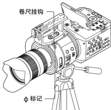
φ 标记和卷尺挂钩与影像传感器位于一个平面上。若要测量本机和被摄体之间的精确距离，请使用此标记或卷尺挂钩作为参考。可以将卷尺末端钩在挂钩上，然后测量与被摄体之间的距离。
