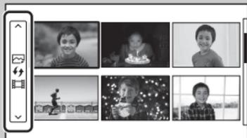
要选择所需文件夹，先选择影像索引画面左边的条，然后按控制拨轮的上 / 下部分。可以通过按控制拨轮的中央来切换静止影像播放与动态影像播放。也可通过触摸左边的滚动条来选择一个文件夹。通过触摸滚动条的中央，可在播放静态影像与播放动态影像之间切换。
