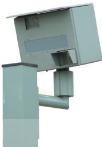
荷製 GATSO Ku 新 K 頻雷達系統
