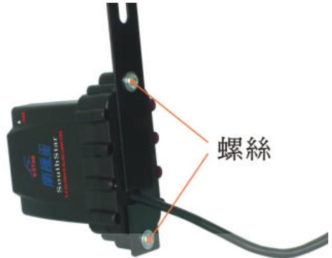
4 將 L 型吊板或是專用型長條型吊板固定於水箱罩或保險桿下方進氣霸內，螺絲鎖緊以前請調整室外主機的角度，讓主機呈與水平 90 度垂直正向朝前，使其能發揮最大功效。
