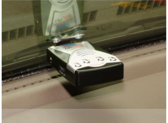
8-2、GPS 顯示副機也可利用磁鐵座或是止滑墊安裝於車內各處(例如儀表板上方)，接上點煙插座電源即完成架設。插入汽車點煙器之電源插頭內有保險絲請勿任意移除不用。
