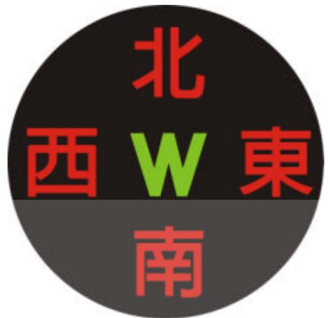
當 GPS 衛星雷達無法正確取得衛星訊號時，電子羅盤則順時針旋轉顯示，表示系統處於搜尋衛星訊號當中，此時 GPS 衛星雷達之固定系統警示功能會暫時失效。
